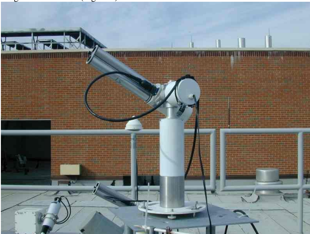
Figure 9: Photomètre exécutant une procédure GOSUN.
