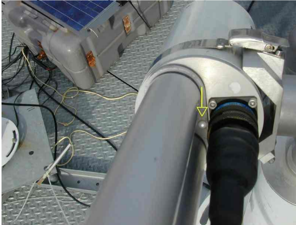
Figure 10: Exposé au soleil le collimateur porte une tache sur le repère de cadrage
