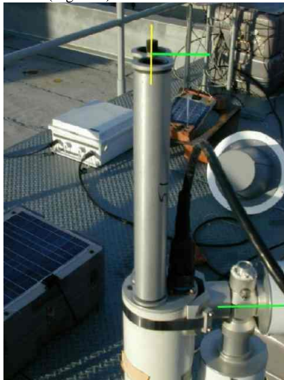
Figure 3 : L'axe de la section transversale de collimateur (jaune) doit être exactement perpendiculaire à l'axe du moteur zénithal du robot (vert)
