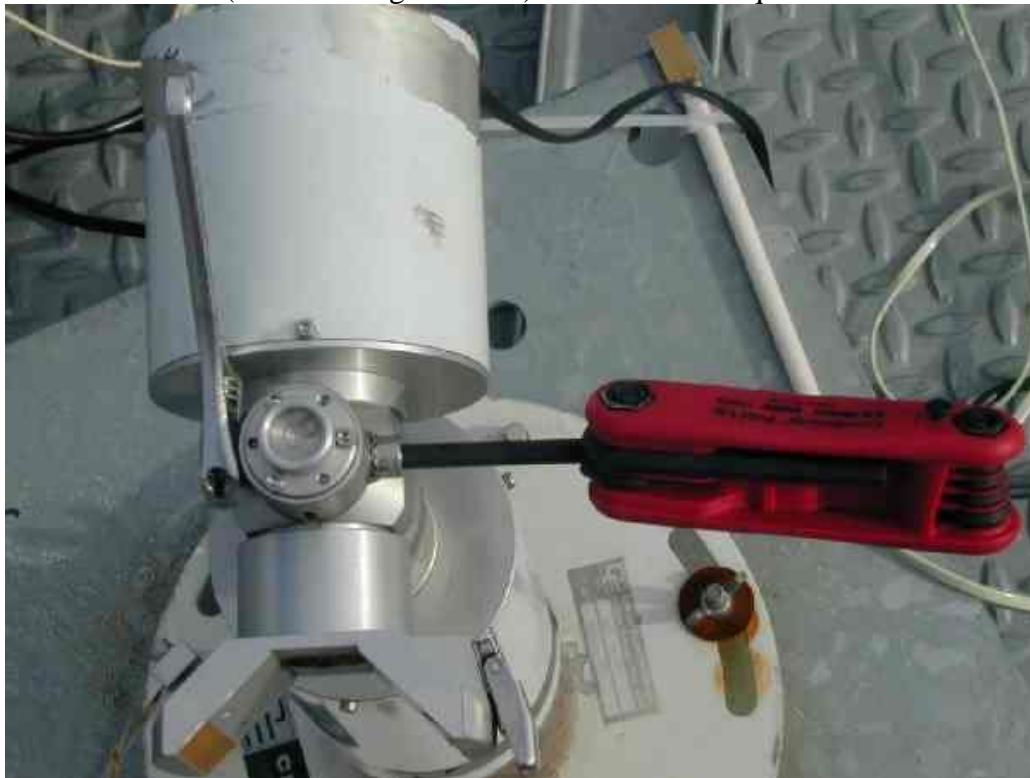
Figure 7 : Ajustement du boulon zénithal
