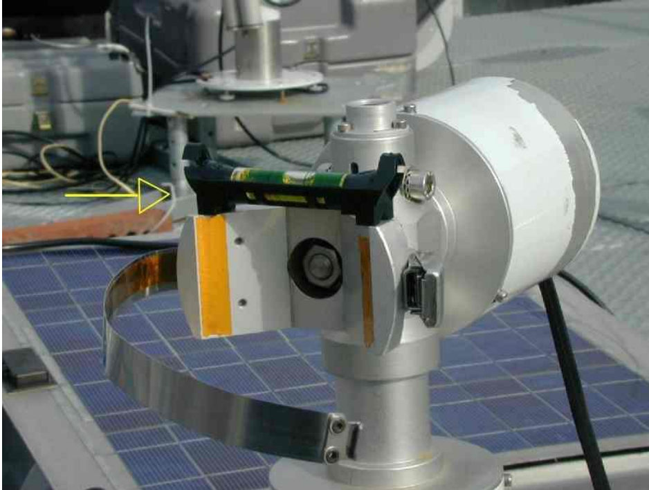
Figure 5 : Nivellement du V du robot (point d'attache principal du capteur)
