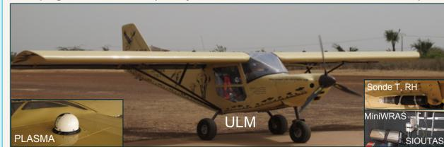
Fig. 4. ULM utilisé pour les vols scientifiques, équipé de : photomètre PLASMA, compteur de particules miniWRAS, sondes T, RH et impacteur en cascade SIOUTAS
