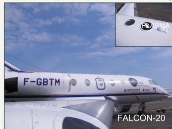
Fig. 7. L'avion de recherche, Falcon 20 de l'unité SAFIRE, équipé du photomètre PLASMA
