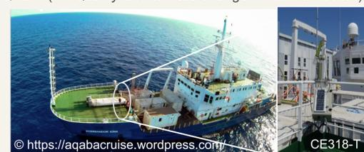
Le photomètre triple a été adapté par LOA et CIMEL pour cette application mobile (bateau).
