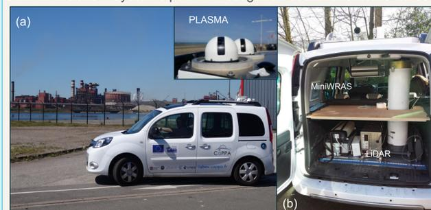
Fig. 1. (a) CaPPA Mobile – mesures sur un des sites industriels de Dunkerque (b) Instruments installés dans la voiture
