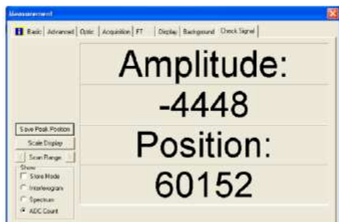
Figure 21 : L'onglet Mode Signal avec l'option ADC Count où on peut voir les contes numériques du détecteur.
