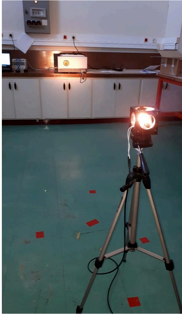
Figure 3.19: Expérience de détermination de l'ILS au centre du CNES sur le site de Aire-sur-l'Adour.
