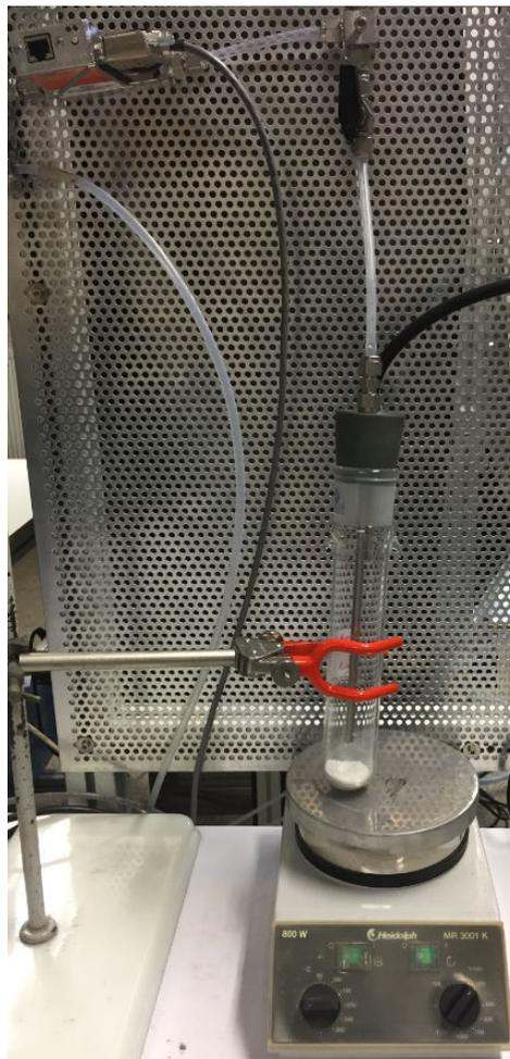
FIGURE 2.2 – Photo de la partie génération du dispositif expérimental avec, en haut à gauche le régulateur de débit massique et au centre, le tube à essai contenant les aérosols volcaniques provenant du volcan Chaitén.
