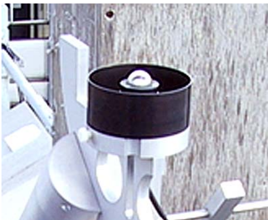
Fig 3.3.3) Photo et coupe schématique du diffuseur du spectroradiomètre Spuv01
