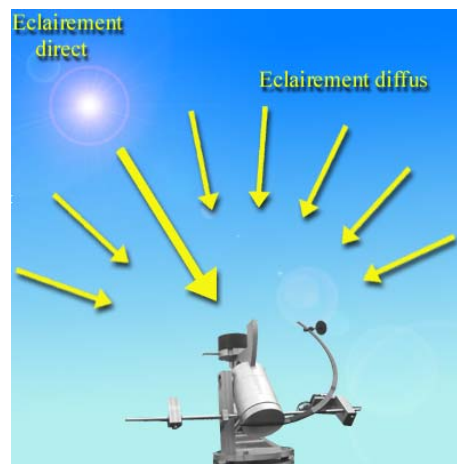
Fig 1.2.2) Eclairages direct et diffus UV mesurés par l'appareil
