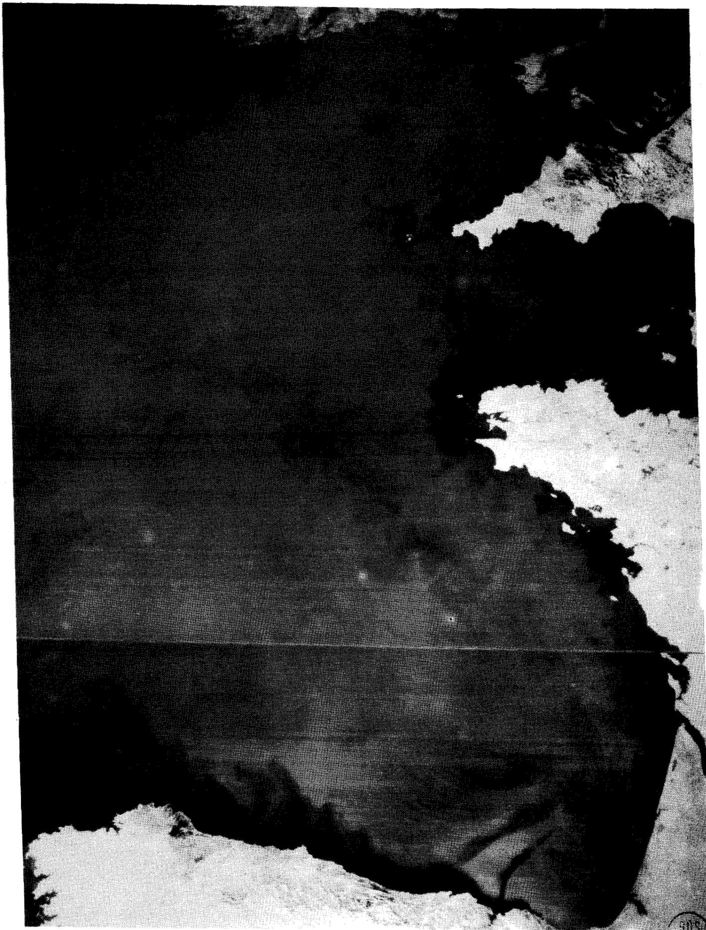
Planche VIII : Observation HCMM du 21 septembre 1978 à 13h32 TU, canal dans l'infrarouge : les teintes les plus sombres correspondent aux températures les plus faibles. Fronts de marée à l'Ouest de la Bretagne, près du Cap Cornwalls, entre l'Irlande et l'Angleterre. Upwelling à la limite du plateau continental à l'Ouest de la Bretagne. Upwellings le long des côtes espagnole et portugaise.
