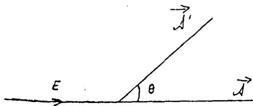
L'intensité diffusée dans une direction  $\vec{s}$  faisant l'angle  $\theta$  avec la direction d'incidence  $\vec{s}$  par une particule d'espèce  $i$  recevant l'éclairement  $E$  est
