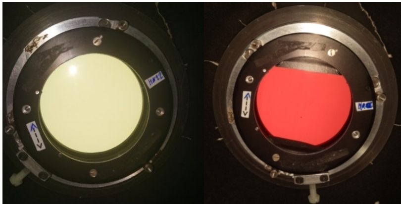
FIGURE 12 – Analyseurs de type HN22 (gauche) pour le VIS-NIR et HR (droite) pour le SWIR installés sur la Sphère Polar
